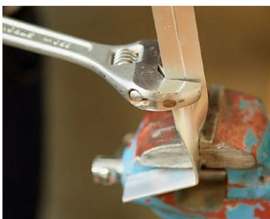
**5 AUFHÄNGEBÜGEL** Als Türschloss wird ein einfaches Metallplättchen an eine der Seitenwände geschraubt. Nun geht es noch an die von Walter Blaser selber entwickelte Aufhängevorrichtung. Vom Aluminiumprofil schneidet er ein rund 25 cm langes Stück ab und biegt es im Schraubstock rechtwinklig ab. Anschliessend fasst er das Profil mit dem Rollgabelschlüssel und verdreht es um 90 Grad. Zum Schluss spannt er das
